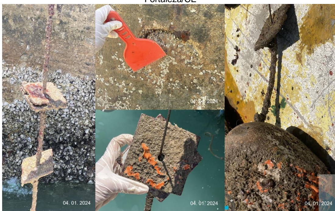
Figura 3 – Vistoria e retirada das placas na 1ª coleta (janeiro/2024) realizada no Porto de Fortaleza/CE
